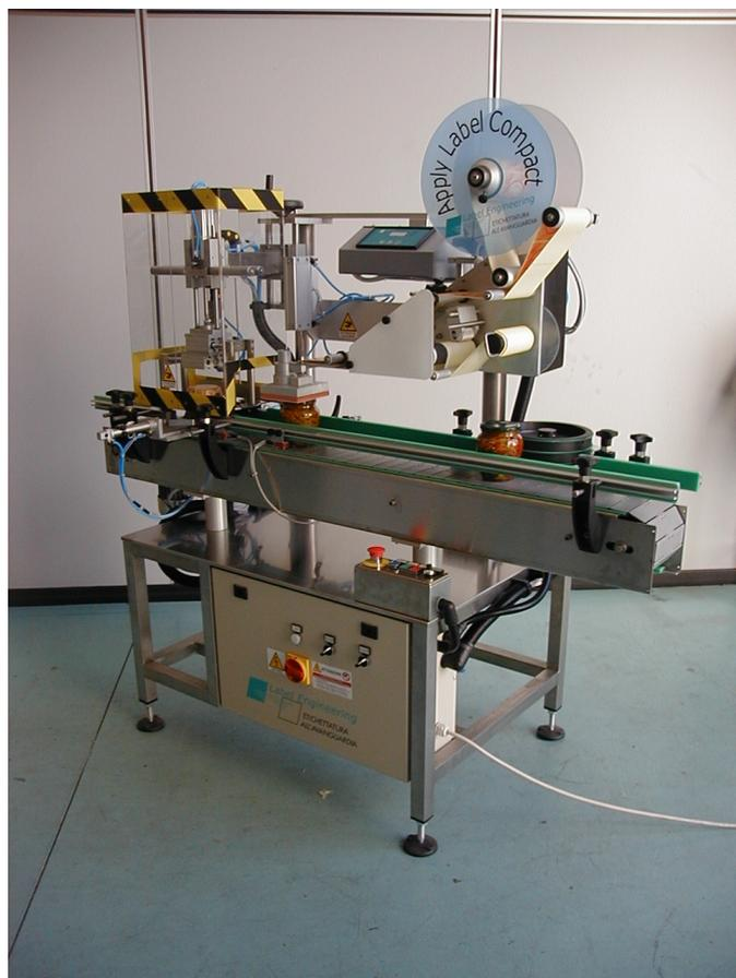
**Linea di etichettatura per applicazione di etichetta superiore su vasetto di conserve con sistema di copertura coperchio a «straccetto».**
