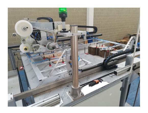
Sistema di movimentazione cartoni stesi, completo di testa pneumatica di etichettatura idonea all'applicazione di etichetta identificativa sul cartone, con riposizionamento dello stesso nel magazzino di scarico.
