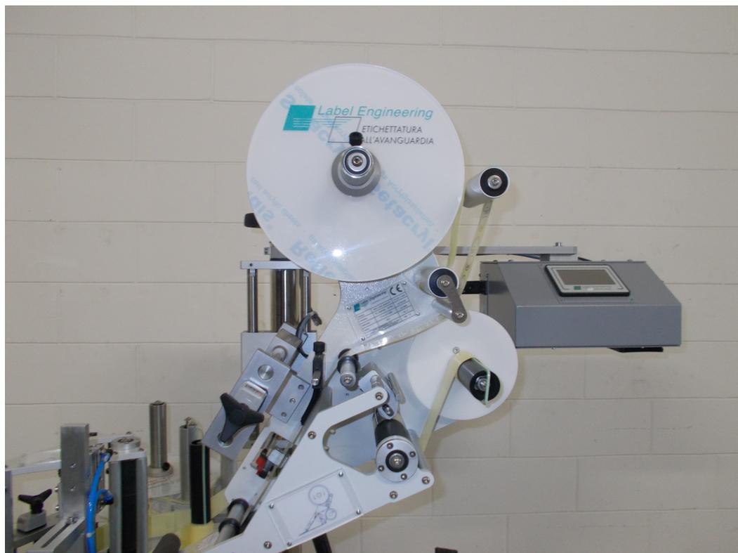
**Le teste di etichettatura APPLY LABEL COMPACT TS** sono caratterizzate da soluzioni tecnologiche innovative, gestite da **elettronica integrata o in controller separato**, versatili e costruite con modularità.
