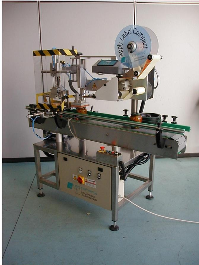
**Ligne d'étiquetage pour l'application d'une étiquette supérieure sur pots de conserves avec un système de recouvrement du couvercle avec un effet « tissu ».**
